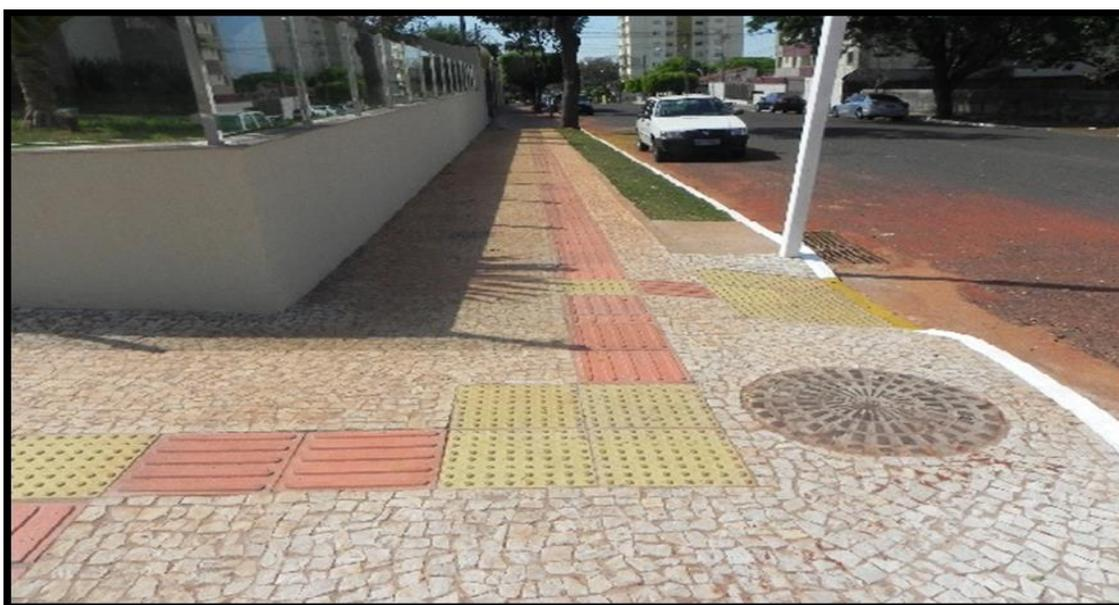
**Figura 2** – Calçada com um piso especial para ajudar na locomoção dos deficientes visuais
